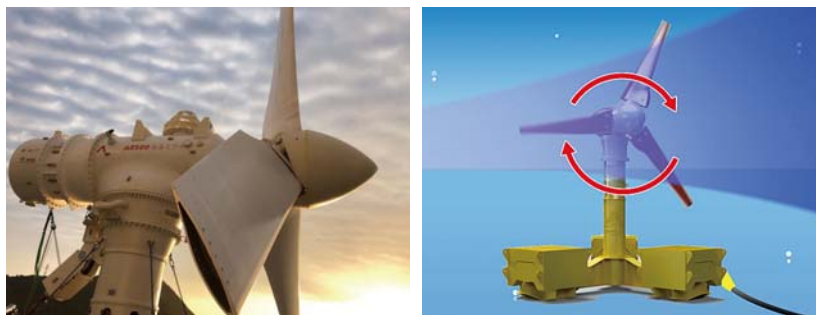
潮の運動エネルギーを使い、ブレードを回して発電する(出所:九電みらいエナジー)
